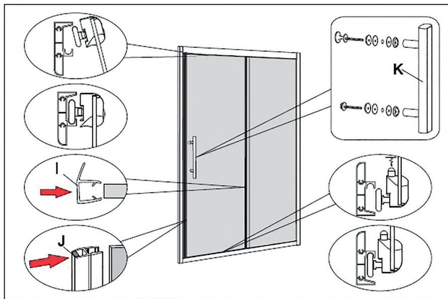
Собрав все детали еще раз проработайте всестыки силиконовым герметиком. Оставьте на **24 часа** для полного застывания, после чего душевой перегородкой можно пользоваться
